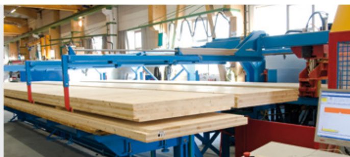
Système de chargement automatique également adapté aux panneaux
