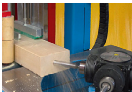
Perçages aux extrémités
