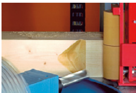
Encoches centrales et encoches de ferme d'arêtières
