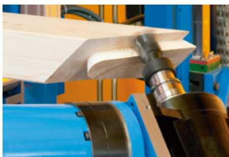
Liaisons en queue d'aronde au niveau de l'empannon
